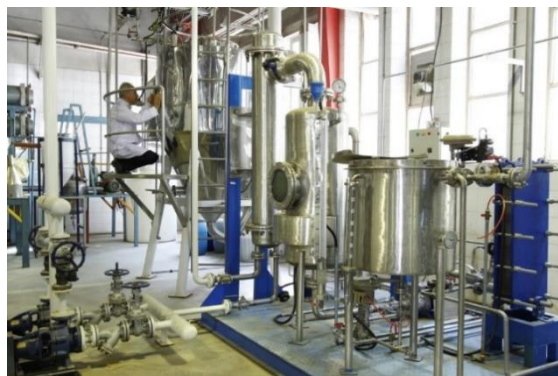
شکل ۱۴. استخراج مواد مؤثره گیاهی به روش جریان ناهمسو (مقیاس پایلوت)
